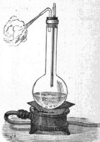
Fig. 108. — Determinación del grado 100 de un termómetro.
